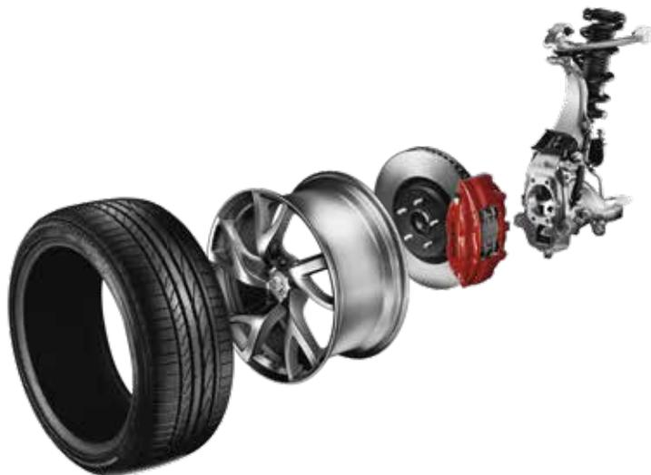
**ÉTRIERS DE FREIN À 4 PISTONS SUR DES ROTORS AVANT DE 355 MM.** L'équilibre ne s'applique pas seulement aux virages. Les plus grands freins jamais conçus, avec des rotors avant de 355 mm, permettent de stopper le puissant Z avec la force d'adhérence des étriers de freins à 4 pistons. Les conduits spécialement conçus permettent de préserver l'efficacité et offrent une puissance de freinage prévisible et précise.
